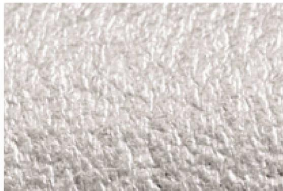
Il polietilene espansofondo, inserito in un giunto, controlla la profondità del sigillante e agisce come coadiuvante di tenuta, senza aderire al sigillante.
